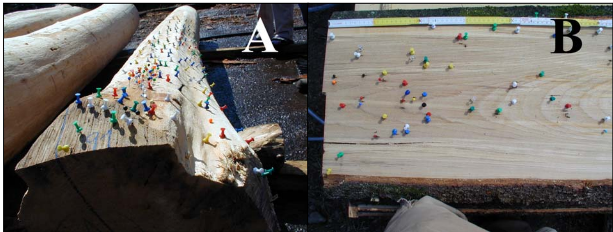
Abb. 3: Einbohrlöcher auf der Stammoberfläche (A) und der Schnittfläche von Buchenbrettern (B) aus dem Hunsrück.
